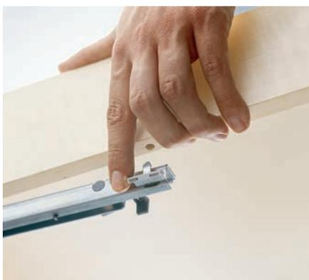
Для установки направляющие вытаскиваются вперед, пока штырь фиксатора не войдет в отверстие в боковине ящика.
