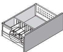
Комплектация: 2 направляющие на 50<sup>1</sup> кг с BLUMOTION, 2 двустенные царги высотой 83 мм, 2 декоративные заглушки с логотипом Blum, 2 держателя задней стенки (D), 2 крепления фасада, 1 комплект релингов<sup>2</sup>, 1 комплект BOXSIDE, 1 поперечный разделитель длиной 1 077 мм под раскрой, 6 держателей поперечного разделителя, 1 межсекционная стенка.
