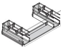
Комплектация: 2 направляющие на 30<sup>1</sup> кг с BLUMOTION, 2 двустенные царги высотой 83 мм, 2 двустенные царги под мойку, 2 декоративные заглушки с логотипом Blum, 4 держателя задней стенки (D), 2 крепления фасада, 4 комплекта релингов<sup>2</sup>, 4 держателя второго релинга, 1 комплект держателей задней стенки под мойку, 1 комплект адаптеров под мойку.
