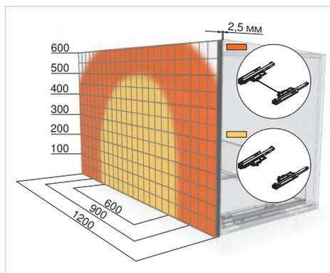
На рисунке показана область срабатывания LEGRABOX с TIP-ON BLUMOTION высотой С, номинальной длины 500 мм с установленным синхронизатором
