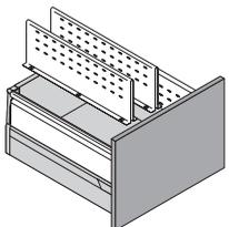
Комплектация: 2 направляющие на 30<sup>1</sup> кг с BLUMOTION, 2 двустенные царги высотой 83 мм, 2 декоративные заглушки с логотипом Blum, 2 держателя задней стенки (D), 2 крепления фасада, 1 комплект релингов<sup>2</sup>, 1 комплект BOXSIDE, 2 межсекционные стенки.
