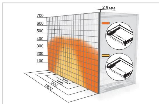
На рисунке показана область срабатывания TANDEMBOX с TIP-ON BLUMOTION высотой D, номинальной длины 500 мм с установленным синхронизатором
